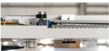
Presión neumática para mayor estabilidad de corte
